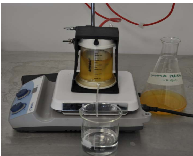
Imagen 3. Proceso de concentrado de poli-electrolito en una celda de ultrafiltración marca amicon ®
