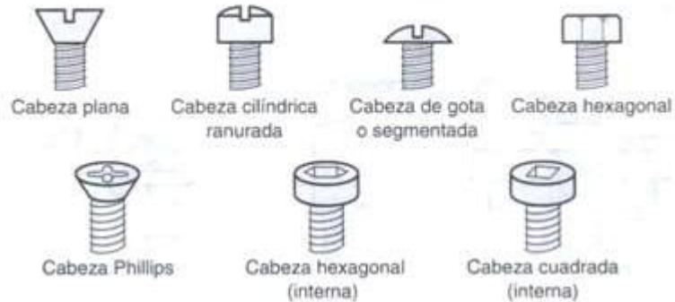
FIGURA 31.2. Diferentes estilos de cabeza disponibles en tornillos y pernos. Hay varios estilos de cabeza adicionales que no se muestran.
