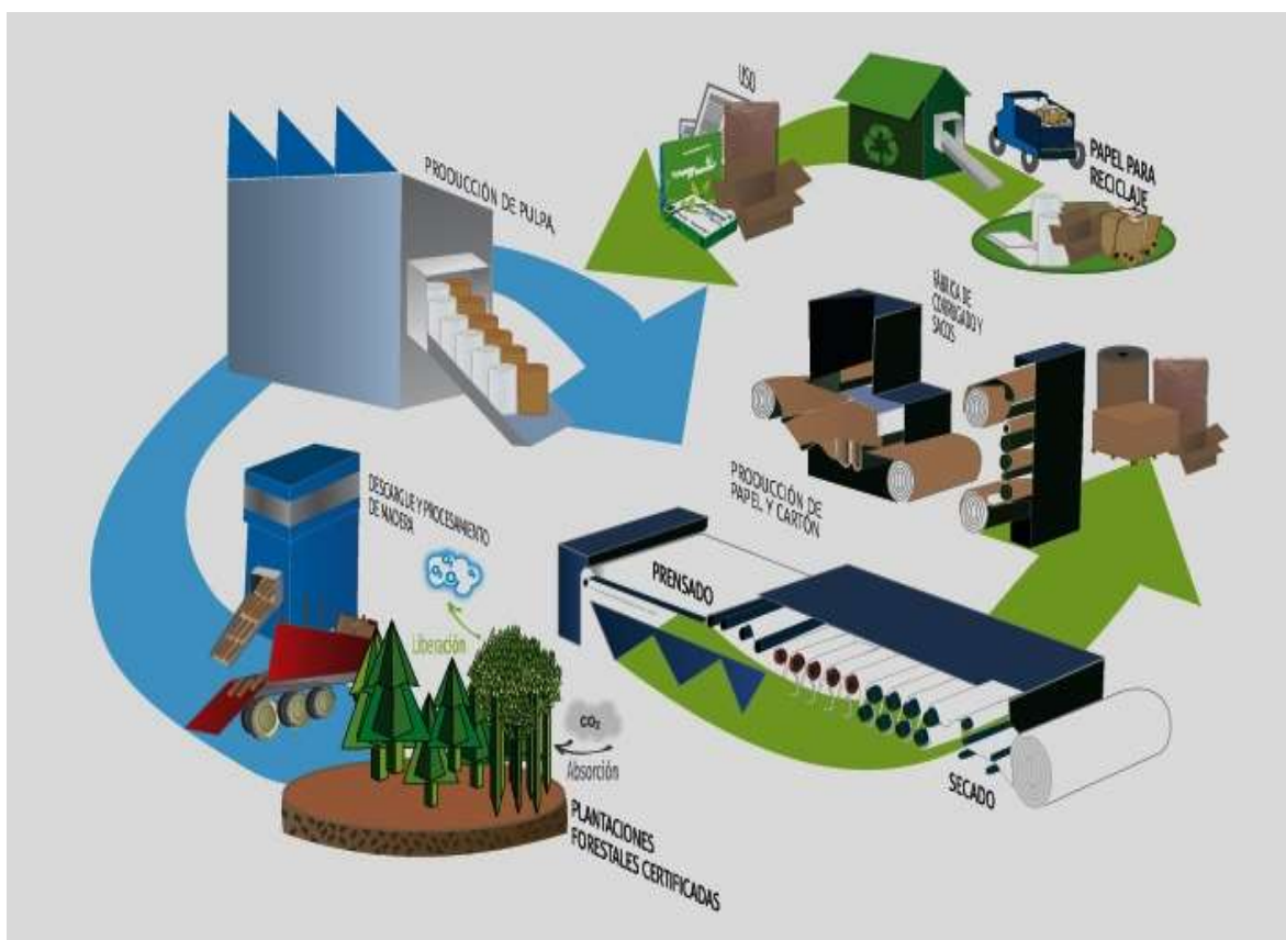
Figura 1. Proceso productivo de Smurfit Kappa Cartón de Colombia S. A.
