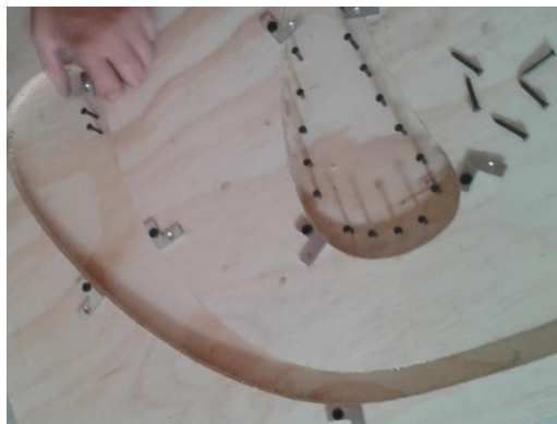
Ilustración 28 Realización matriz de curvado
