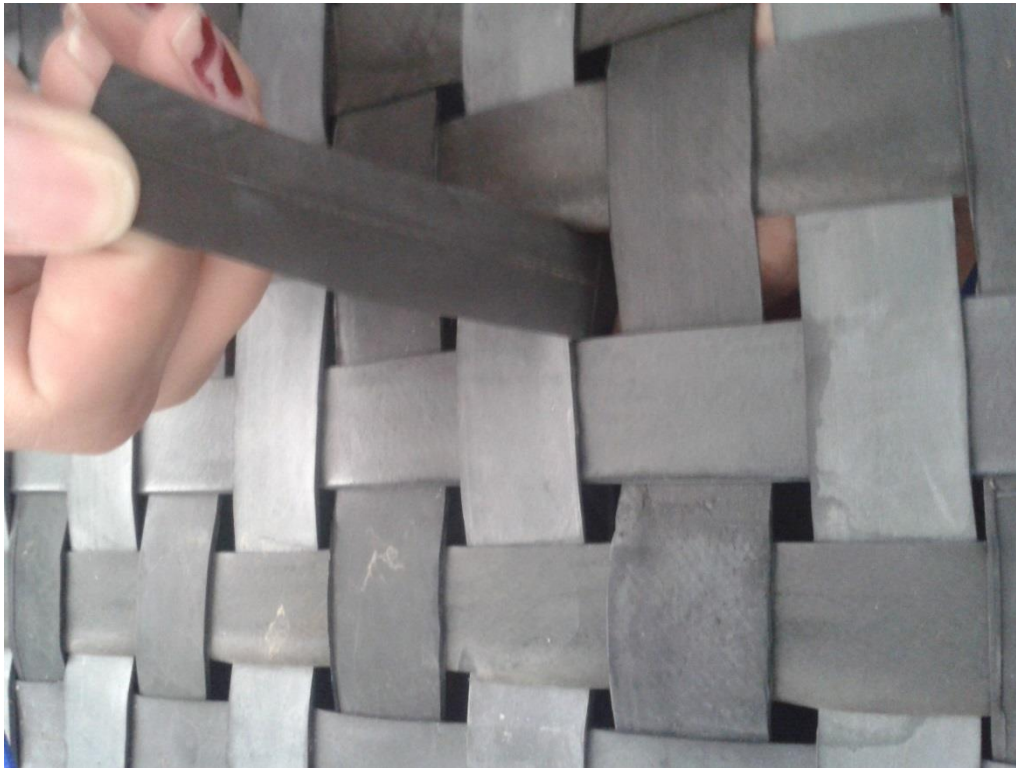
Ilustración 36 Realización tejido de sistema de anclaje
