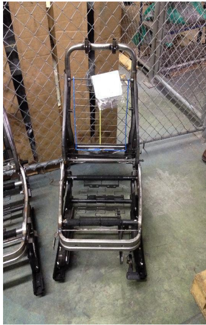
Ilustración 12 | Estructura interna del asiento del conductor | Fuente: El autor
