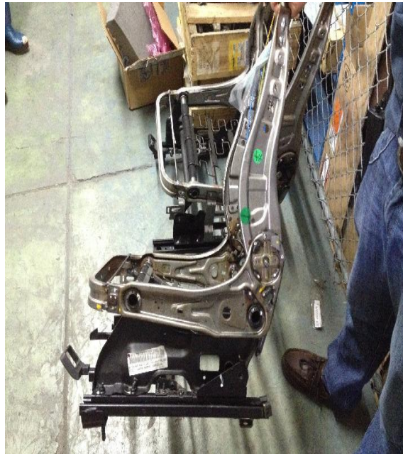
Ilustración 13 | Estructura interna del asiento del conductor | Fuente: El autor
