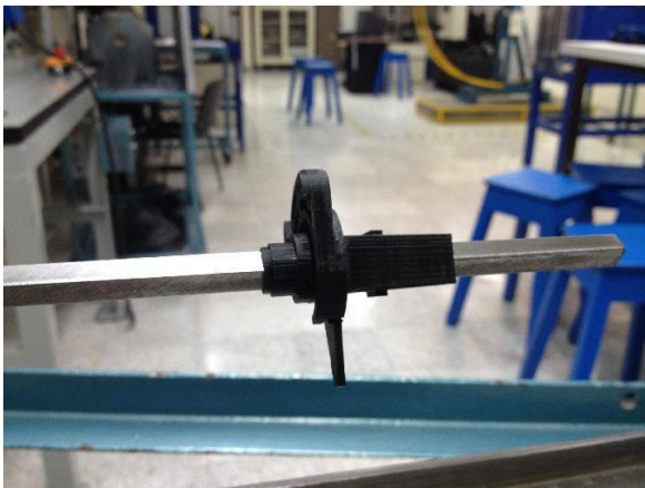
Ilustración 38 | Montaje de pieza en máquina de torsión | Universidad Autónoma de Occidente | Fuente: El autor
