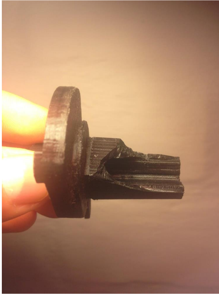
Ilustración 42 | Fractura pieza impresa | Fuente: El autor
