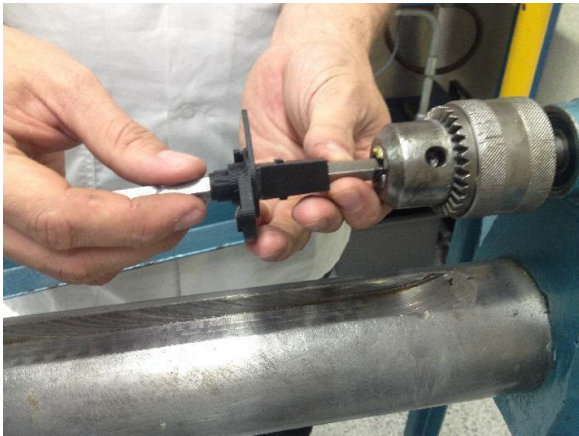
Ilustración 40 | Montaje de pieza en máquina de torsión | Universidad Autónoma de Occidente | Fuente: El autor
