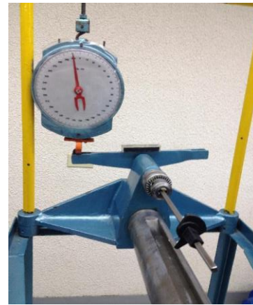
Ilustración 39 | Montaje de pieza en máquina de torsión | Universidad Autónoma de Occidente | Fuente: El autor
