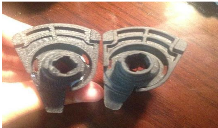
Ilustración 34 | Pieza impresa (izquierda) junto con la pieza original | Fuente: El autor
