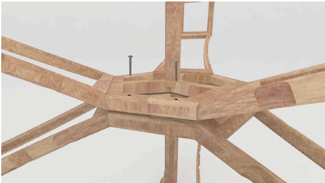
Fig. N° 12 Detalle ensamble Módulo a módulo vertical. Fuente: López y Sanclemente (2015).
