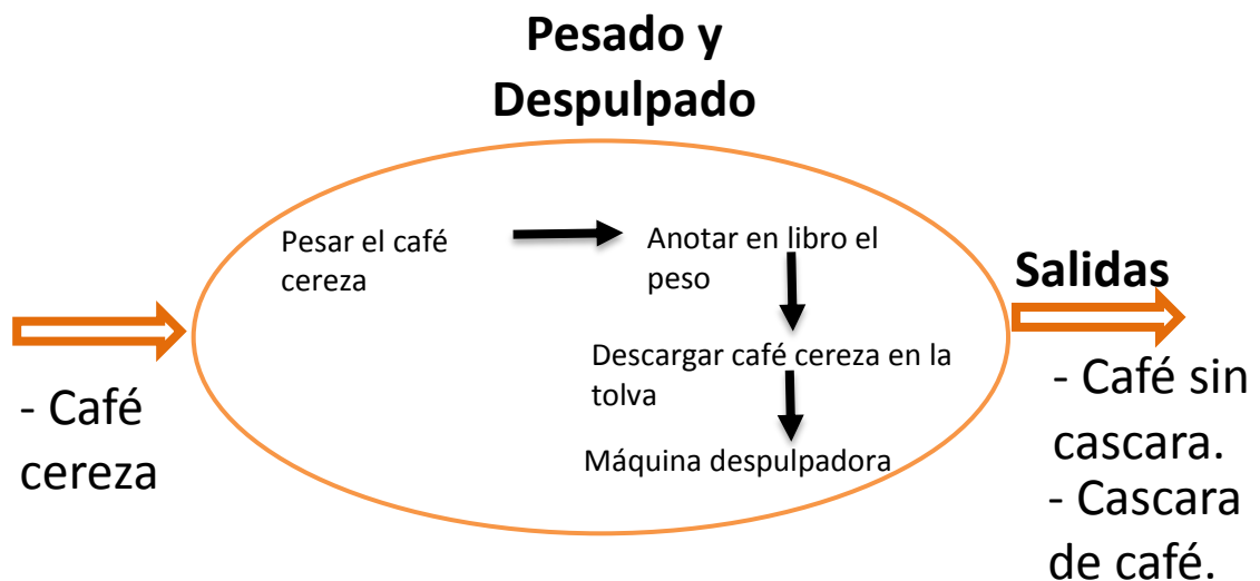
Gráfica 6. Diagrama del proceso de pesado y despulpado en la empresa ABC.
