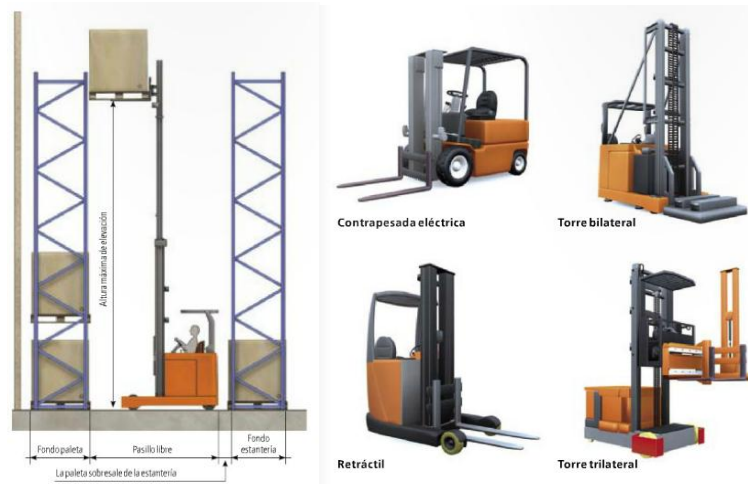
Figura 17. Herramientas para el manejo de carga en la bodega. Tomado de ALFA RACKS S.A.
