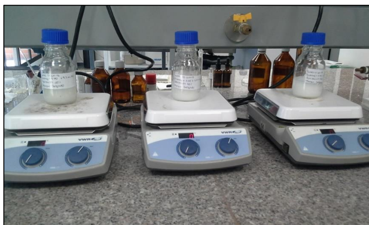
Ilustración 11. Fotografía al inicio de la adición de HCl para llevar a cabo la modificación del Eudragit E 100 y obtención de las sal clorhidrato de Eudragit E 100 (Cl Eu).
