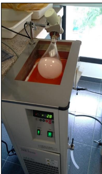
Ilustración 12. Fotografía de la etapa de congelamiento de uno de los materiales poliméricos obtenidos.
