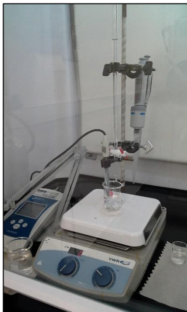
Ilustración 8. Fotografía del montaje experimental para la realización de valoraciones potenciométricas.
