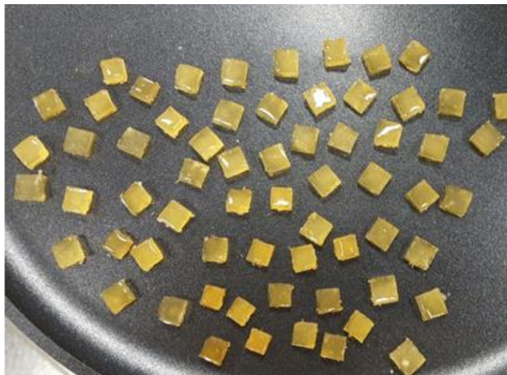
Figura 7. Hidrogeles en el sartén de teflón antes de ser llevados al horno
