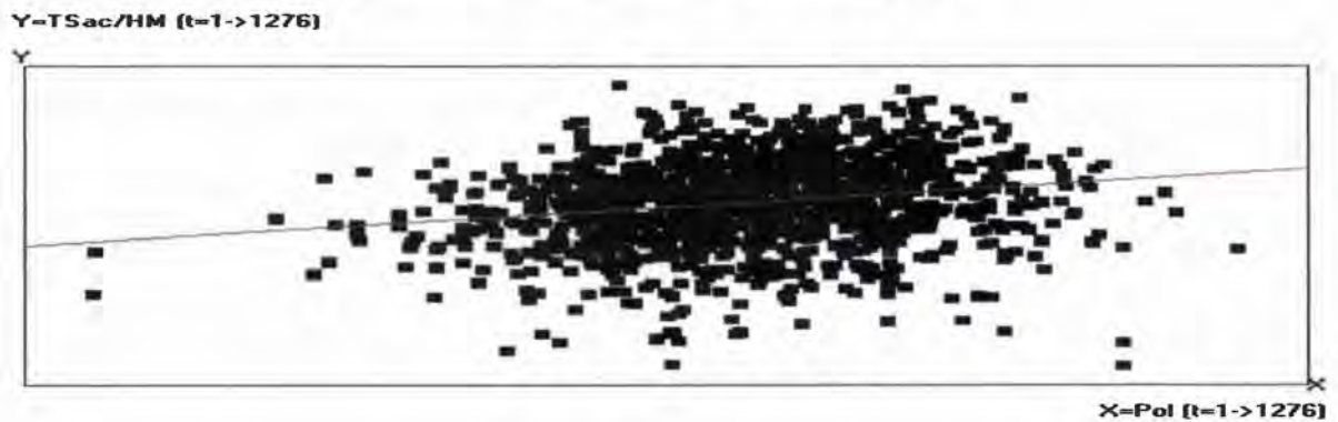
FIGURA No.6 – SACAROSA OBTENIDA EN FUNCIÓN DEL POL APARENTE MEDIDO, INGENIO 1999-2005
