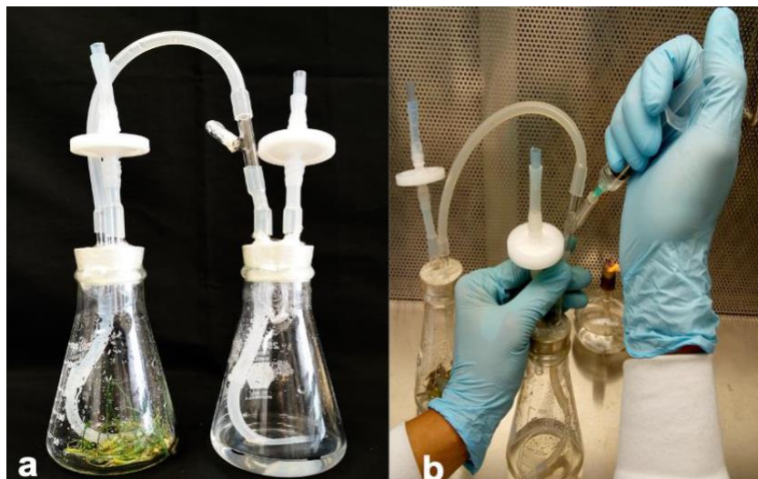
Figura 4: a, SIT instalado, a la izquierda Erlenmeyer con plantas y a la derecha Erlenmeyer donde se agrega inicialmente el medio de cultivo. b, inyección de medio de cultivo por el tapón tipo septum. 14
