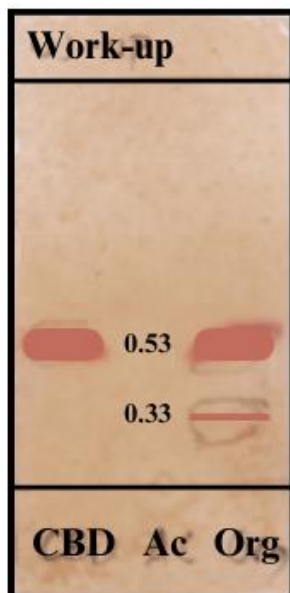
Figura 2. Placa cromatográfica del ensayo de descarboxilación de CBD utilizando DBU y 5 equiv. de Mg
