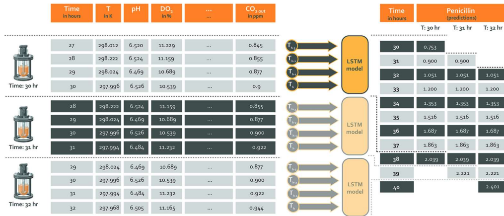
Imagen 1. Preparación de secuencias de entrada y salida para el modelo LSTM en el soft sensor.
