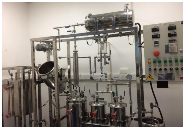
Figura 7. Planta de extracción semi-piloto PSE solutions.
