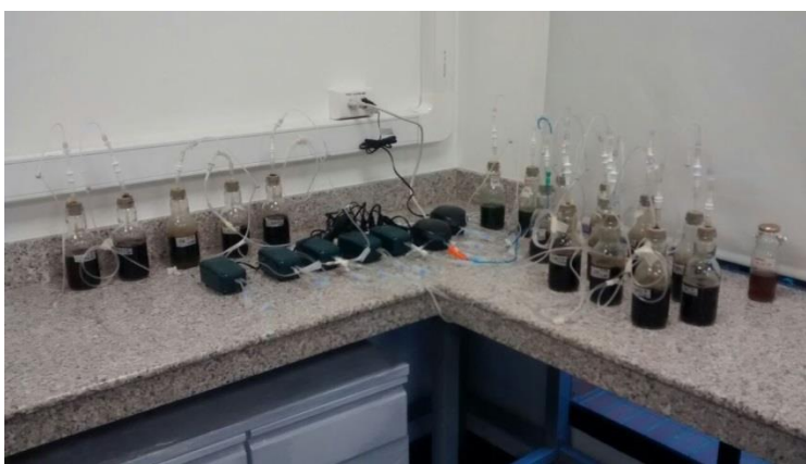
Figura 1- Biorreactores de Chlorella Vulgaris en vinazas de la caña de azúcar
