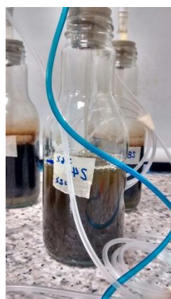
Figura 1- Biorreactores de Chlorella Vulgaris en vinazas de la caña de azúcar
