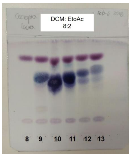
Figura 13. Cromatografía planar de fracciones recogidas en Cromatografía flash con sistema metanol 100%. Fase móvil: diclorometano /acetato de etilo 8:2
