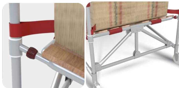
Ilustración 11: Mecanismo unión entre parales y estiba (rosca universal). Mecanismo de inclinación (bujes)
