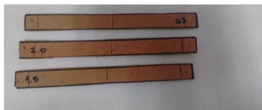
Figura 3: Probetas planas de cuero y cartón para ensayo de flexión.
