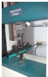
Figura 3: Probetas planas de cuero y cartón para ensayo de flexión.
