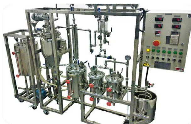
Figura 3. Planta de extracción sólido-líquido, construida por la firma de ingeniería PSE SOLUTIONS.
