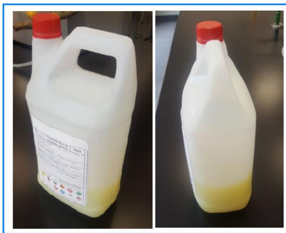
Imagen 9. Expansión de envase de almacenamiento por formación de gases.
